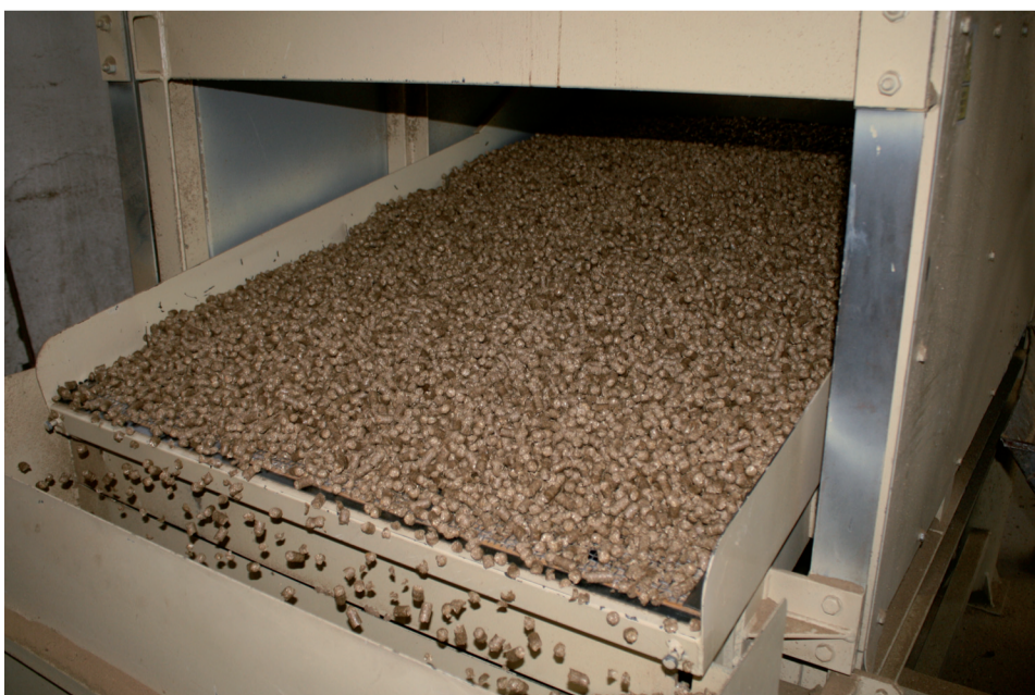
Na vibračnom dopravníku sa pelety zbavujú posledných nečistôt.
